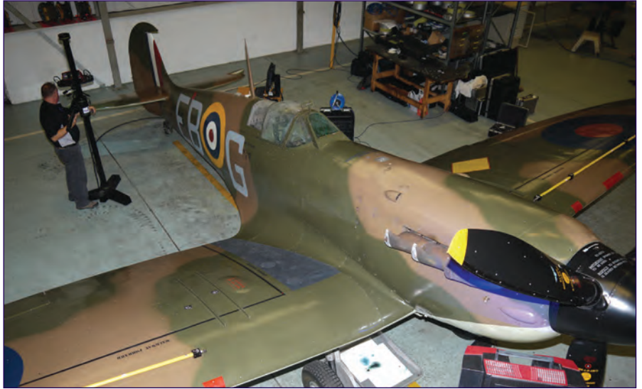
Mitarbeiter des Fertigungsbetriebs scannen die letzte erhaltene WWII Spitfire, die im aktiven Einsatz in der Luftschlacht um England stand, um diese aus historischen Gründen nachzubauen.
